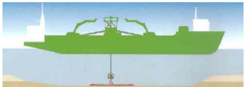
Mise en place de la couche de soubassement (CDV)
