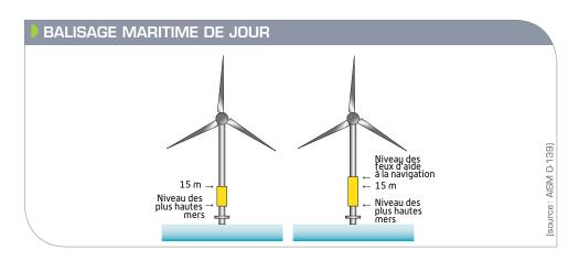
Le balisage du parc éolien en mer de Dieppe - Le Tréport sera composé d'un balisage maritime et d'un balisage aéronautique conformes à la réglementation en vigueur.
