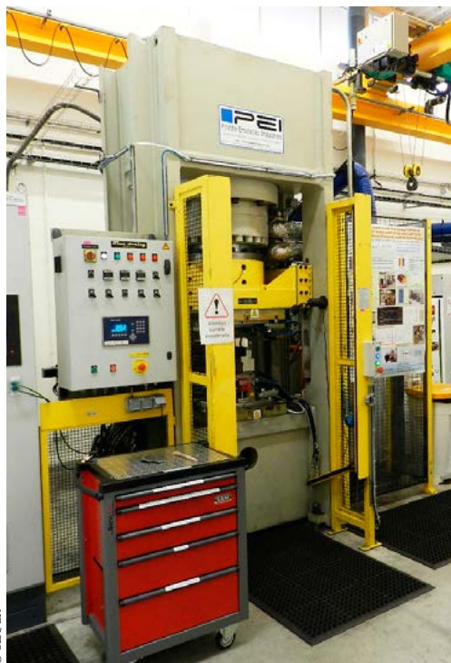
À gauche : presse industrielle permettant de fabriquer des plaques bipolaires. À droite : plaque bipolaire (composant de pile).
