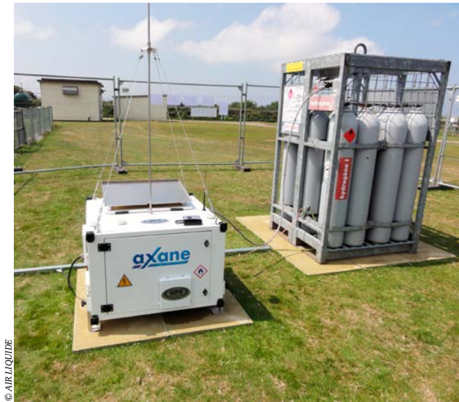
Une pile à combustible et son stockage d'hydrogène dans des bouteilles sous pression. Une solution pour l'alimentation en électricité de sites isolés.
