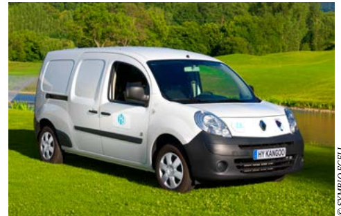
HyKangoo par Symbio FCell, Kangoo ZE Renault équipé d'un prolongateur d'autonomie H 2 .
