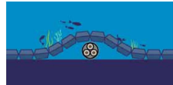
Le matelas béton
