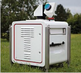
**Type d'instrument :** LiDAR scannant
