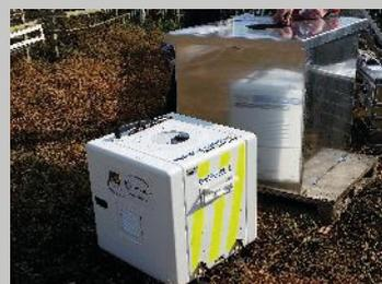
**Type d'instrument :** LiDAR vertical
