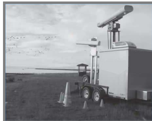
Radar de type « ornithologique » pour détecter les flux de déplacements
