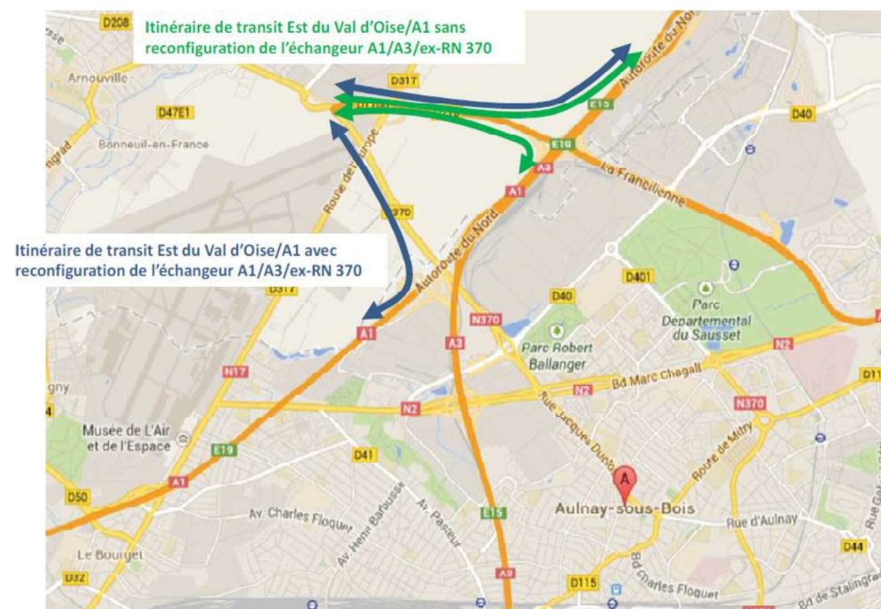
Itinéraires entre l'Est du Val d'Oise et l'A1 avec et sans reconfiguration de l'échangeur A1/A3/ex-RN 370
