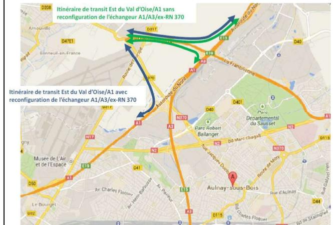
Itinéraires entre l'Est du Val d'Oise et l'A1 avec et sans reconfiguration de l'échangeur A1/A3/ex-RN 370
