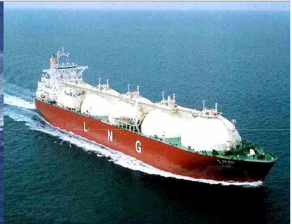
Cuves autoporteuses (sphérique)
