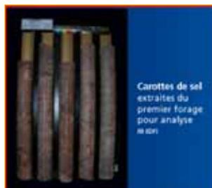
Ces données devraient permettre de déterminer le pourcentage d'éléments insolubles dans ce diapir. Sur le site GDF/Suez de Manosque, les cavités creusées dans le dôme de sel se bouchent peu à peu du fait de l'accumulation de ces éléments insolubles. Le projet est-il de pouvoir creuser d'autres cavités que les douze prévues initialement ou est-il limité à 15 ans ?
