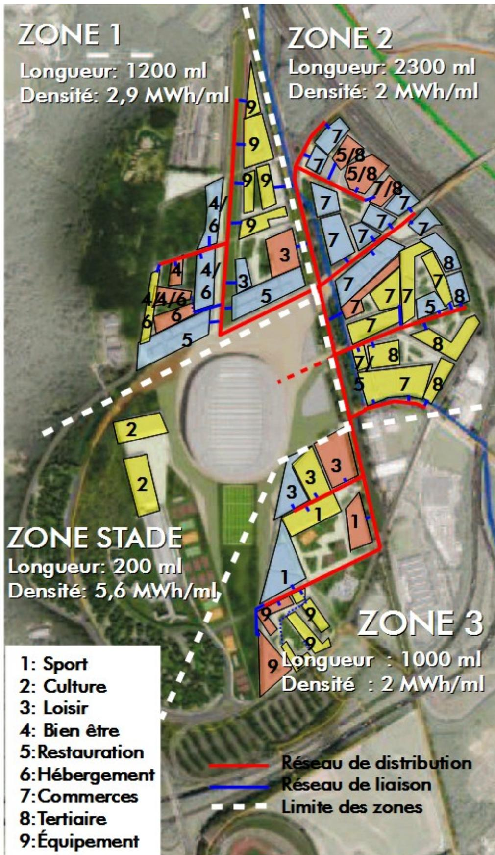
Il est à noter que, dans une première approche, la localisation de la centrale de production n'a pas été identifiée. Le tracé ci-dessus ne présente que le réseau de distribution. Le réseau de transport (qui relie la centrale de production et ce réseau de distribution) devra être pris en compte lorsque la centrale de production aura été localisée.
