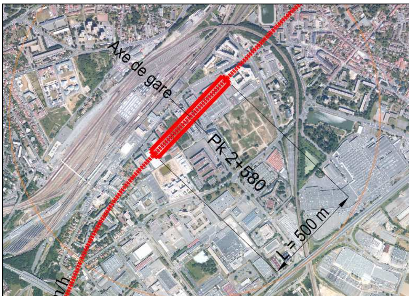
Figure : Principe d'implantation de la gare souterraine à Massy
