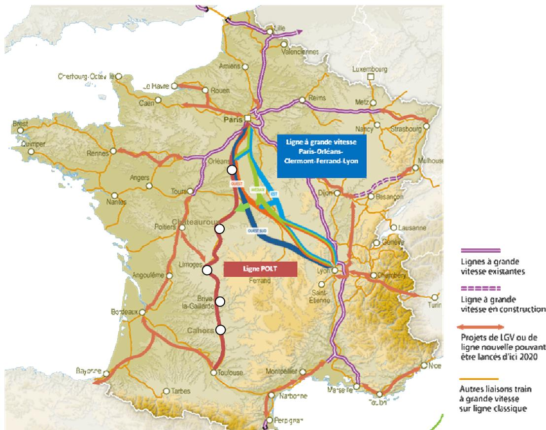
Le projet de LGV POCL prévoit en effet de se raccorder à l'axe POLT en deux endroits différents :
