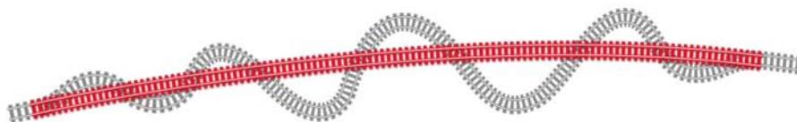
Figure 5 : Il faut reprendre la géométrie de la totalité de la ligne pour améliorer la vitesse sur l'itinéraire
