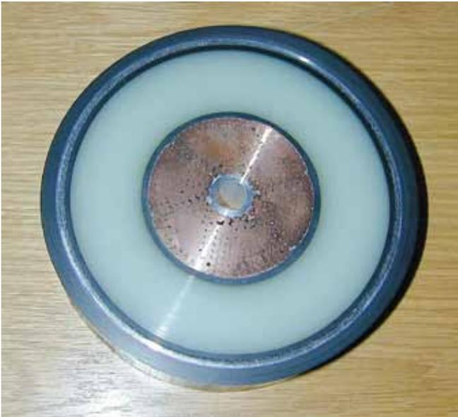
Figure : Coupe du câble 400 000 volts 2500 mm<sup>2</sup> Cuivre utilisé pour la liaison située à proximité de l'aéroport de Madrid.
