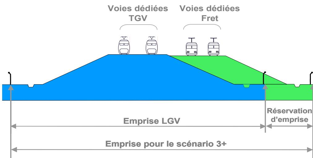
Le schéma ci-après décrit le scénario évolutif composé de la ligne à grande vitesse (en bleu) et de la réalisation successive de contournements fret (en vert) des agglomérations. Le schéma en médaillon représente le corridor mixte réalisé à terme.
