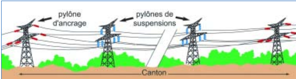
Pylônes d'ancrage et pylônes de suspension
