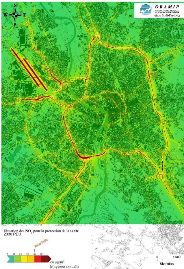
Cartographie de la pollution au NO<sub>2</sub> sur la zone PDU pour le scénario 2030\_PDU (échelle 10m)
