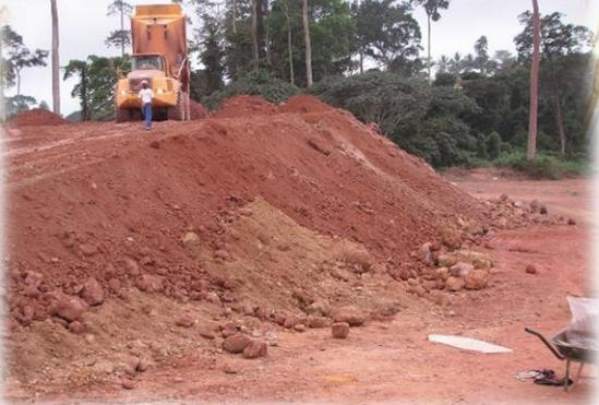
Stockage et homogénéisation des minerais
