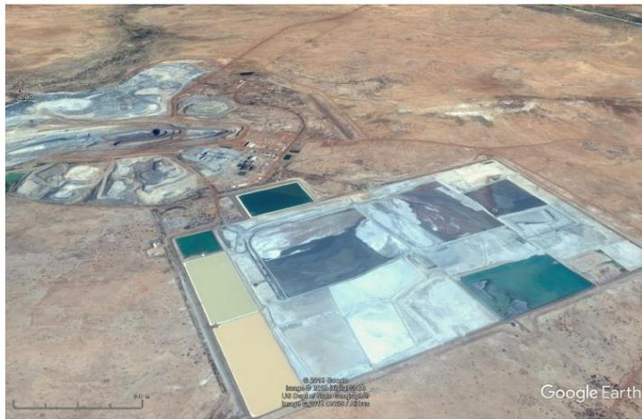
Exposition maximale aux UV et compartimentage de monitoring sur la verse à résidus de 510ha de la Mine d'Essakane (BF)
