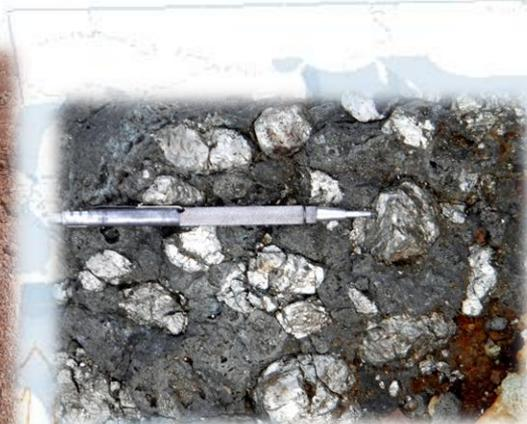
fragment de sulfures : Pyrite et
