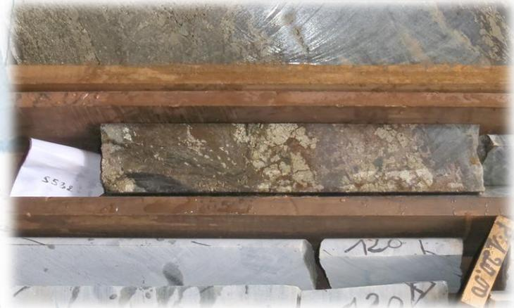
La **pyrite** est un minéral qui se retrouve dans la pierre et qui produit de l'acide sulfurique en s'oxydant au contact de l'humidité et de l'oxygène. Lorsque ce phénomène se produit en dessous d'une fondation, il peut provoquer le soulèvement et la fissuration de la dalle de béton.
