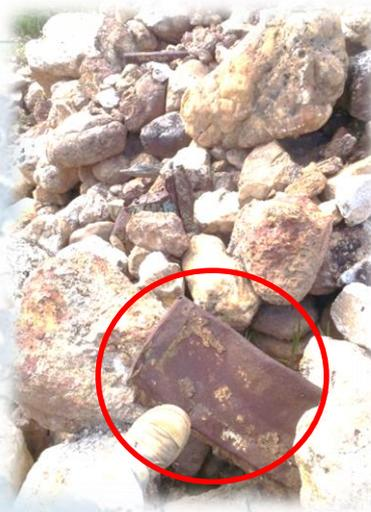
Ancien fond de flat placer orpaillé avec présences de débris métalliques et blocs anguleux pouvant, à la compaction différentielle, cisailer et perforer des géotextiles classiques
