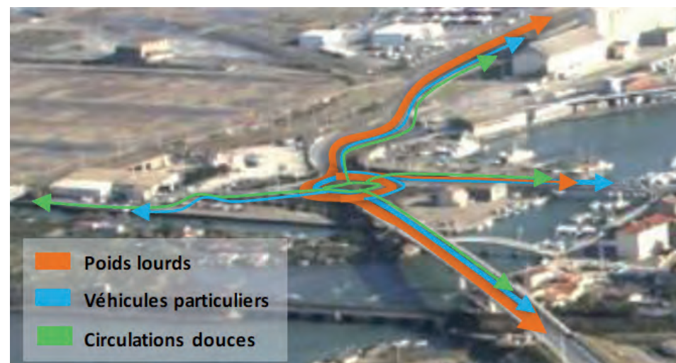
Les superpositions de circulations au niveau du giratoire d'accès au port (source CATRAM)
