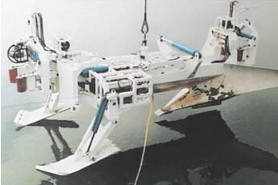
Photo 1 : Exemple de moyens d'ensouillage : charrue
