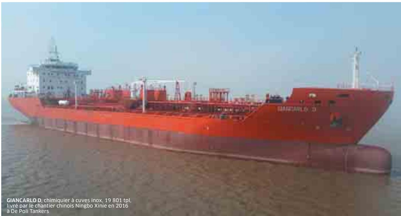
GIANCARLO D, chimiquier à cuves inox, 19 801 tpl, livré par le chantier chinois Ningbo Xinie en 2016 à De Poli Tankers
