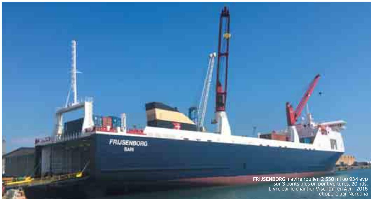
FRIJSENBORG, navire roulier, 2 550 ml ou 934 evp sur 3 ponts plus un pont voitures, 20 nds. Livré par le chantier Visentini en Avril 2016 et opéré par Nordana
