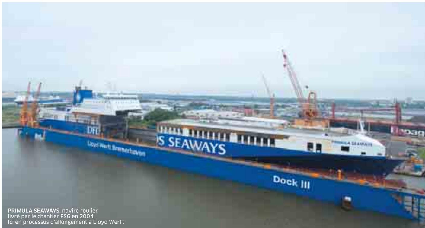
PRIMULA SEAWAYS, navire roulier, livré par le chantier FSG en 2004. Ici en processus d'allongement à Lloyd Werft
