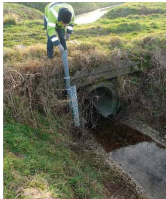
▲ FIGURE 76 Mesures de contrôle des eaux dans un watergang
