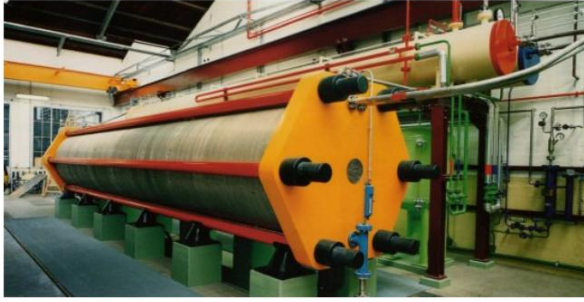
Figure 5 – Electrolyseur alcalin ELT, 760 m 3 /h – 30 bars
