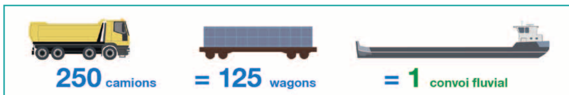
Schéma des besoins pour transporter 5 000 tonnes selon les modes de transport (dossier du maître d'ouvrage)
