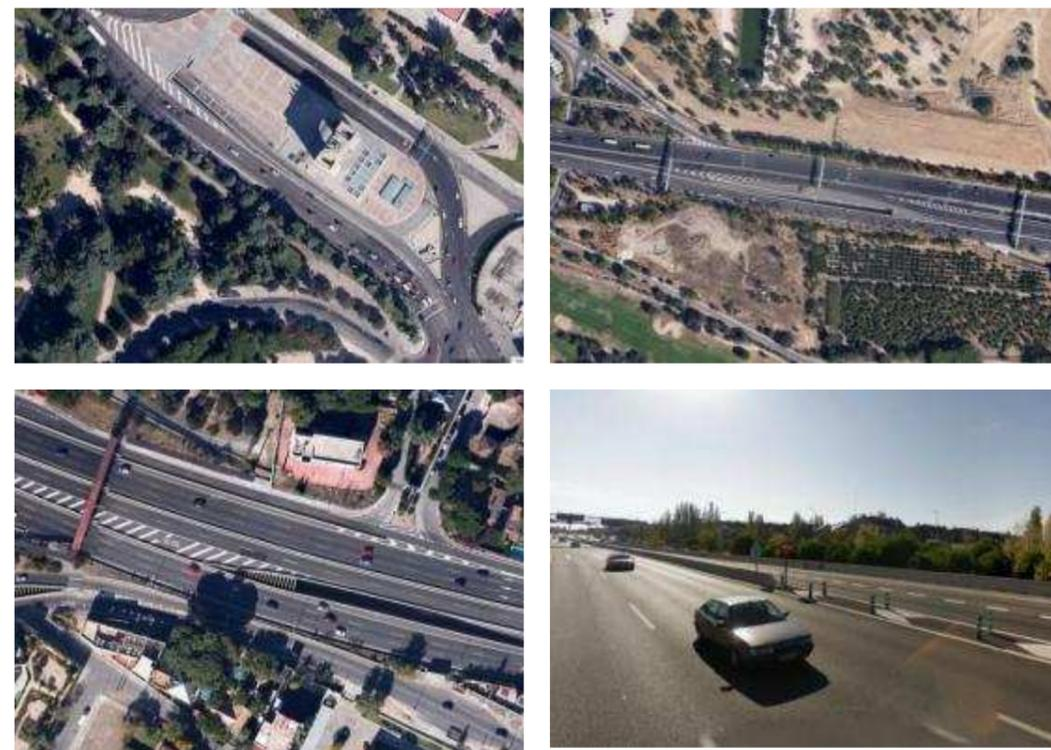
Figure 14 : A6 entre « las Rosas » et « Puerta de Hierro » chaussée centrale 1x2 voies sens alterné (source Google Map)
