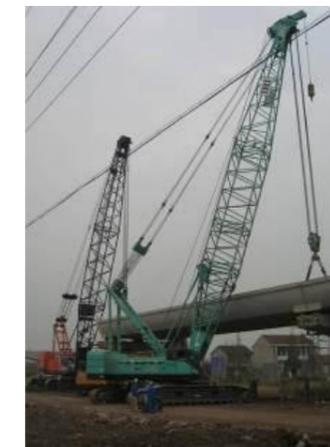
Les engins de levage de type grues routières permettent de manutentionner des éléments ou des structures préfabriquées d'ouvrages d'art dans de très bonnes conditions, grâce à leur performances, à la rapidité et à la souplesse d'utilisation.
