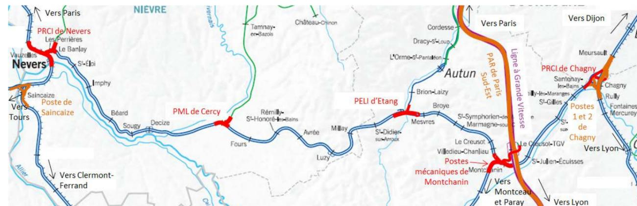
Figure 7 : Rayon d'action des différents postes de la ligne (source RFF)
