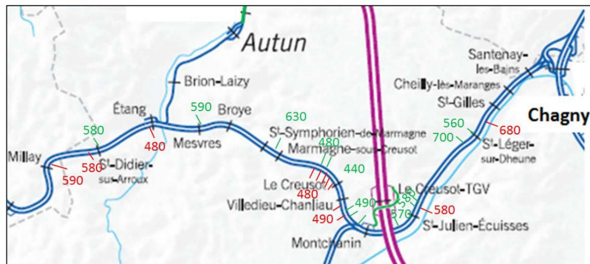
**Figure 19 : Les rayons inférieurs à 700 m (source : schéma d'armement de la ligne)**
