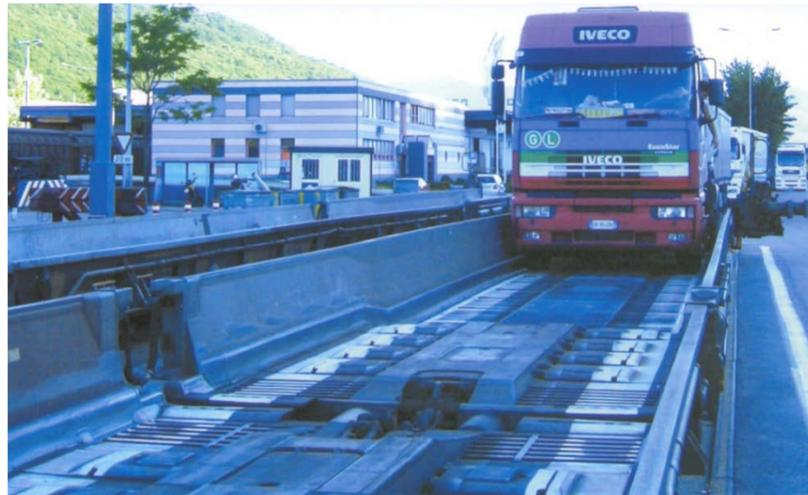
**Figure 33 : Chargement d'un ensemble routier sur wagon Talbot-Bombardier (Source : internet)**
