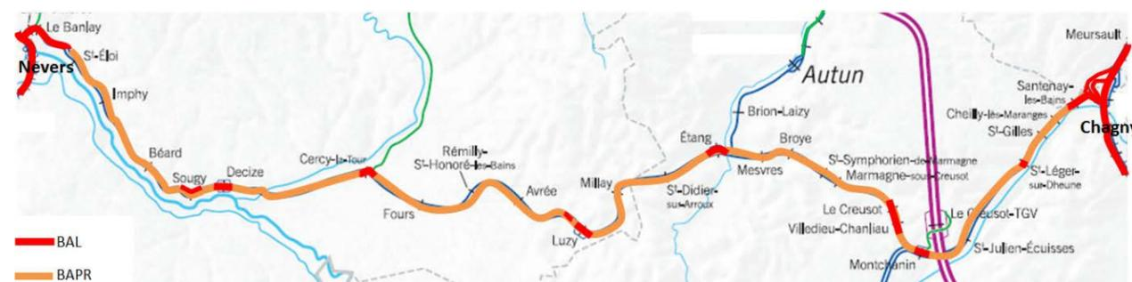
**Figure 5 : Systèmes d'espacement sur la ligne Chagny-Nevers**
