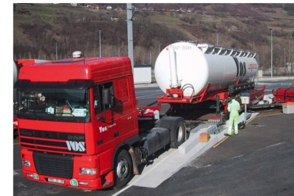
Figure 31 : Exemples de wagon Modalohr : Chargement d'une citerne routière sur wagon Modalohr
