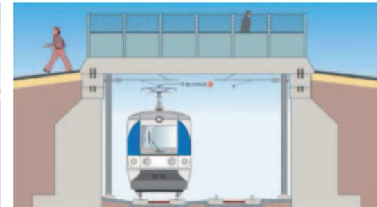
Ouvrage rehaussé avec poteaux, caténaire et garde-corps sur la passerelle piétonne.
