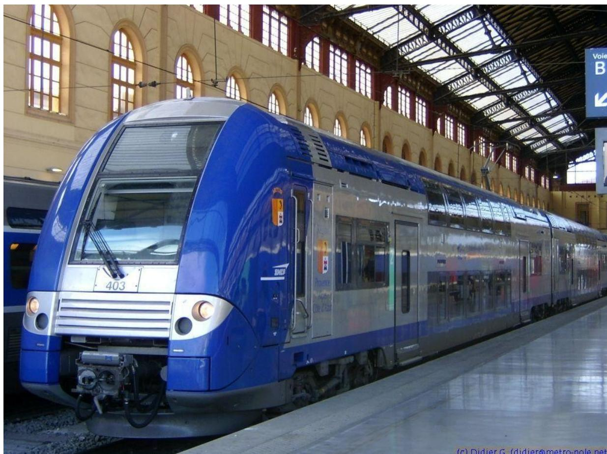
L'Automotrice Alstom-Bombardier Z24500 à deux niveaux préconisée
