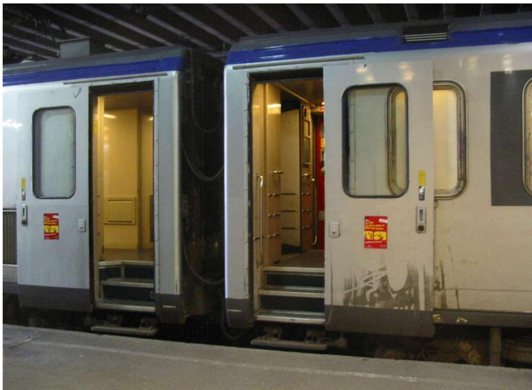
Une automotrice Z2 aux portes étroites et aux quatre marches, ralentissant fortement l'accès en salle, rendant périlleuse la montée à bord avec son vélo, la poussette ou le fauteuil roulant.
