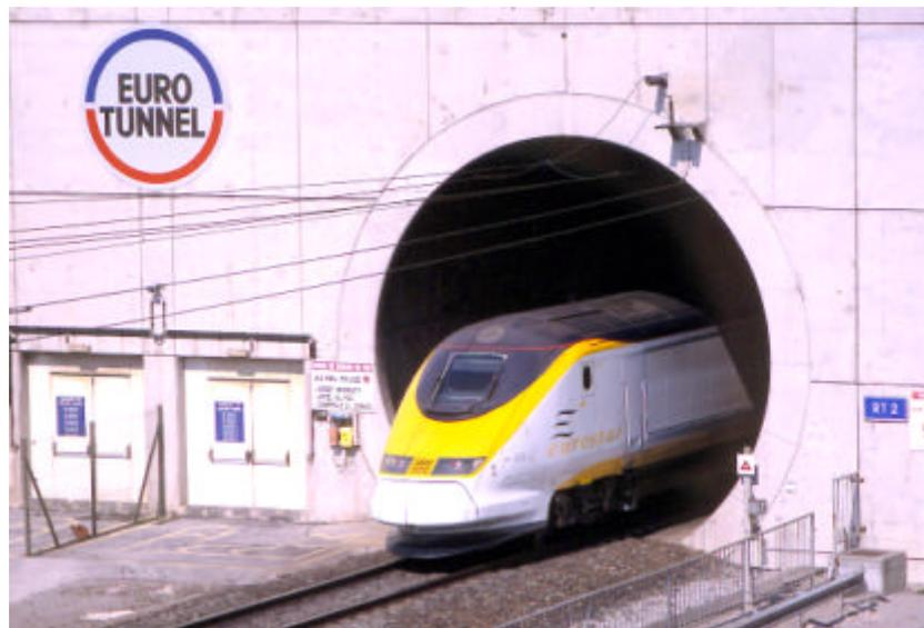
Figure 2 : une rame TMST (Eurostar) au gabarit standard sortant du tunnel sous la Manche. Notez l'espace restant autour du train que les rames Eurotunnel exploitent au maximum.
